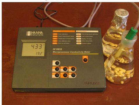
**Рис.9. Определение электропроводности растворов кондуктометрическим методом**
